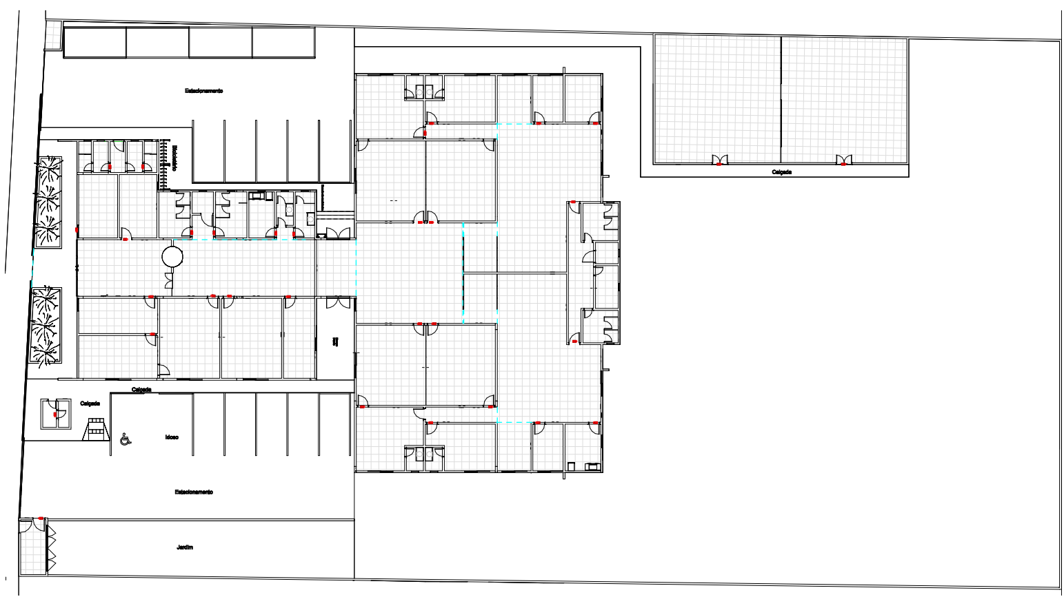
1 Térreo - Luminárias de emergência 1 : 125
