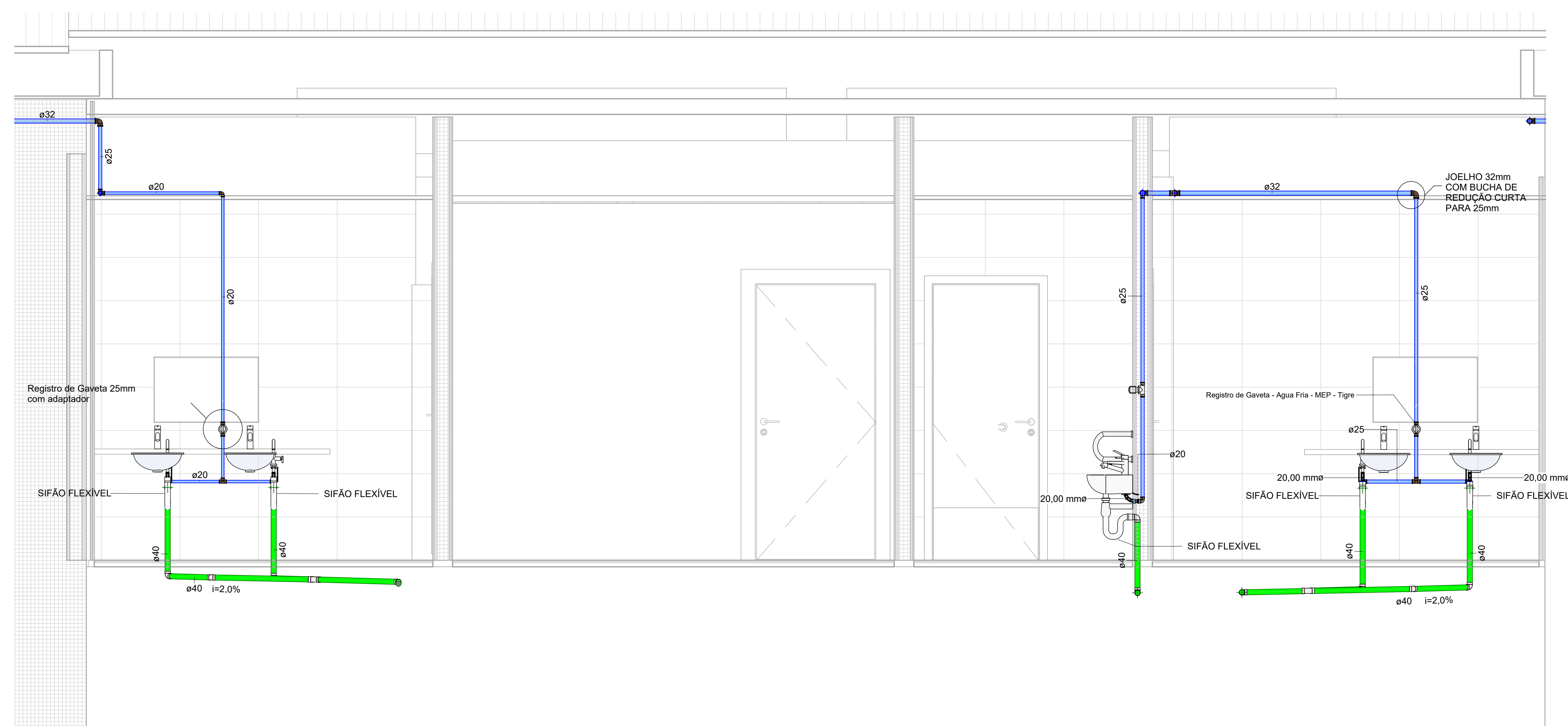
4 Corte 4 - Banheiros Internos Bloco B 1:20
