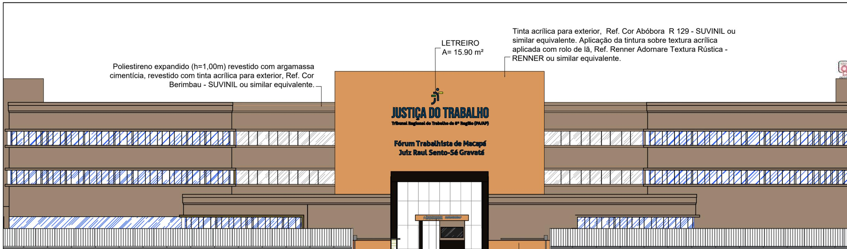
Poliestireno expandido (h=1,00m) revestido com argamassa cimentícia, revestido com tinta acrílica para exterior, Ref. Cor Berimbau - SUVINIL ou similar equivalente.
